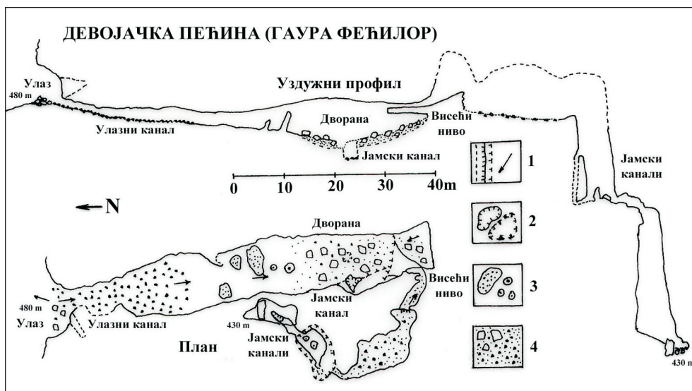
Сл. 2 План и уздужни профил Девојачке пећине. Објашњење: 1-приближно, одсек, нагиб, 2-јамски канал, 3-сталагмити, зоне са сигом, 4-блокови, дробина, глина.
