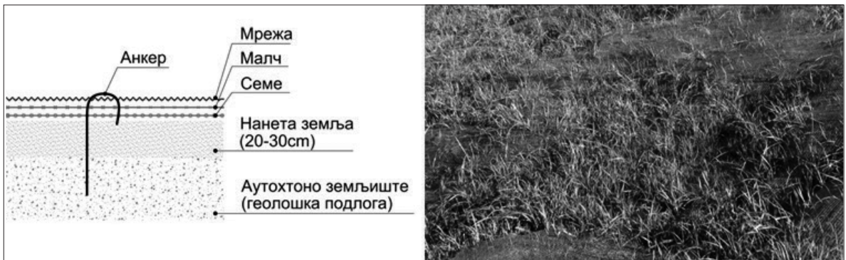
Слика 9. Обнављање земљишног и вегетационог покривача (ски-стаза „Коњарник 1“, јуни 2009) Figure 9. Reestablishing soil and vegetation cover (ski-run „Konjarnik 1“, June 2009)
